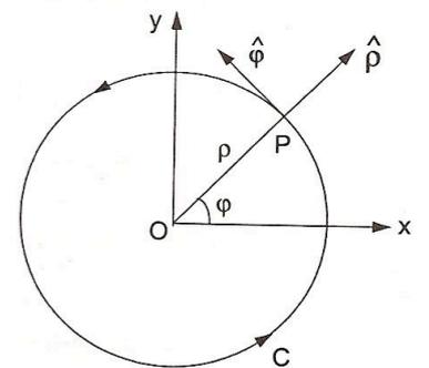
Figura 8.4 Seção transversal do fio
